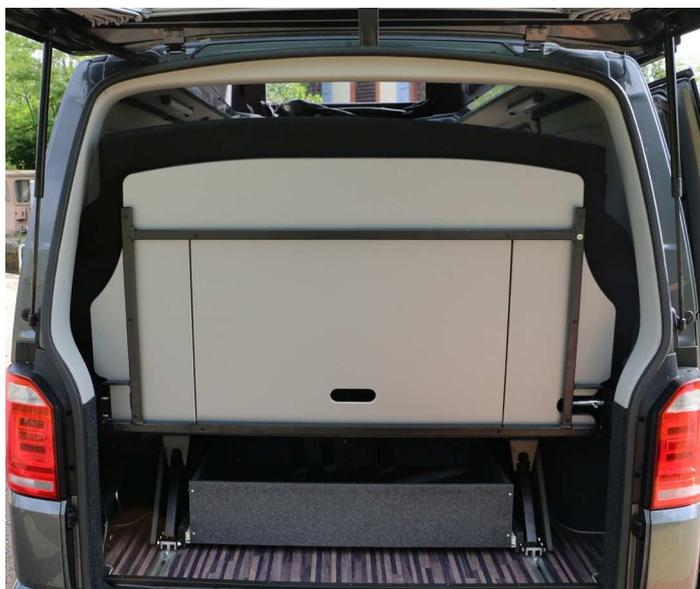
Lorsque la banquette est reculée au maximum, celle-ci vient presque se plaquer contre le hayon, ce qui réduit le coffre au minimum. Le tiroir situé sous la banquette (option) peut être retiré afin de gagner en espace de stockage sous la banquette et de permettre le passage d'objets longs (skis, planches...)
