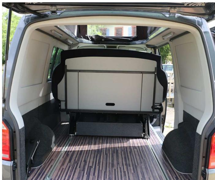
Avancée contre les sièges avants, la banquette offre un grand dégagement arrière qui permet un volume de stockage maximum. En position avancée, la longueur disponible entre le hayon et la banquette est de 1.55m sur une version courte et de 1.95m sur une version longue.
