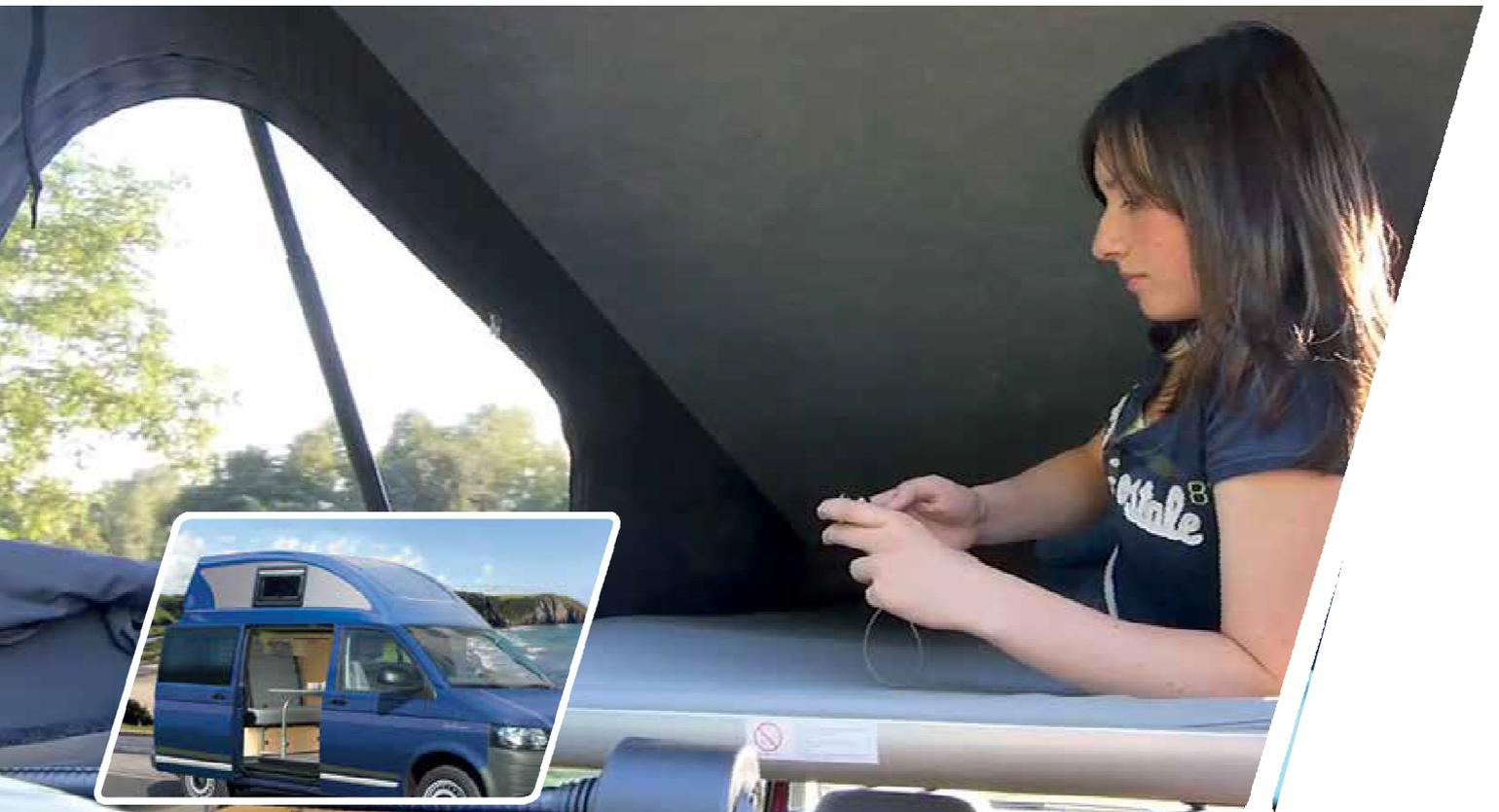
Toit Easy Fit extra plat avec isolation et vérins pneumatiques. Surface de couchage d'environ 195 x 125 cm. Matelas épaisseur 5 cm. La toile de toit intègre 3 fenêtres, les fenêtres latérales sont équipées de moustiquaires pouvant être ouvertes. Toit à coque rigide sur demande.
