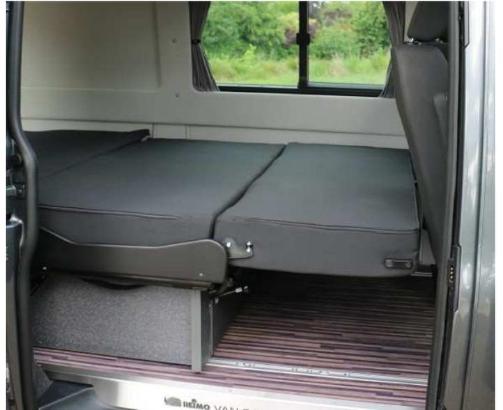
La banquette étant coulissante sur rails, en position lit il est également possible de la positionner en avant ou en arrière. En position avant, il reste un espace de 40 cm derrière la banquette pour une version courte ou de 80 cm pour une version longue.
