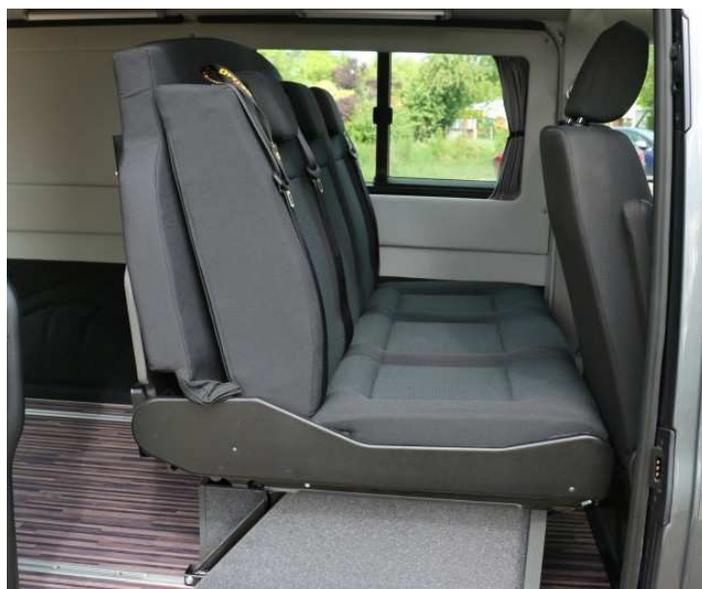
En position avancée au maximum, la banquette vient se coller aux sièges et permet ainsi de bénéficier d'un très grand espace de stockage dans le coffre. La planche arrière du lit vient se plaquer contre l'assise de la banquette afin de libérer un maximum d'espace arrière. La banquette peut également être retirée complètement du véhicule en la sortant par la porte latérale.
