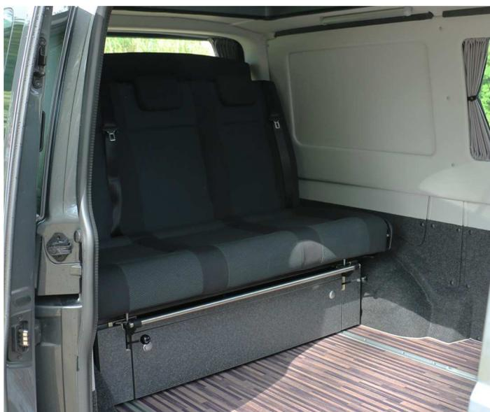
La banquette 3 places coulisse sur l'intégralité du véhicule et en position arrière maximale, permet de bénéficier d'un très grand espace de vie. Les sièges avants étant pivotants, cela permet d'agrandir d'avantage l'espace. La position de la banquette est fixée par des crans situés au niveau des rails, il y a 6 positions sur un véhicule court et 7 sur un véhicule long.
