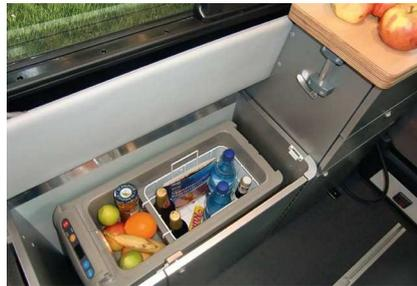
À côté de la cuisine un emplacement dans les coffres bas permet d'intégrer une glacière à compression de 23L
