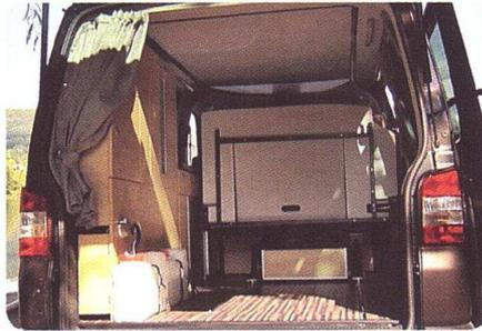
La banquette coulissante permet d'adapter le volume du coffre jusqu'à 4 000 litres (4 800 litres en version longue).
