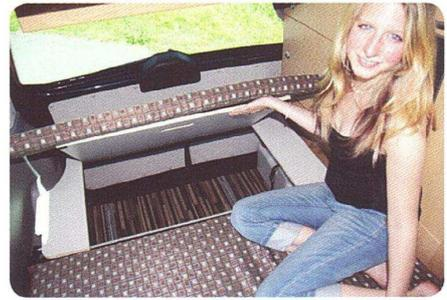
Trappe qui permet le passage des bagages en soute sans sortir d'véhicule. Compartiment éclairé.
