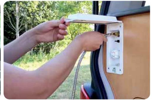
Réservoirs de 32L d'eau propre et 12L d'eau usée, avec en option une alimentation en eau chaude et une connection pour douche extérieure.
