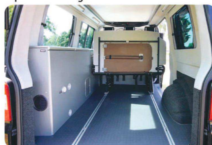
La soute arrière fait 46 cm sous le lit. Le coffre varie en fonction de la banquette et va jusqu'à 4 800 litres en version courte et 5 800 litres en version longue.
